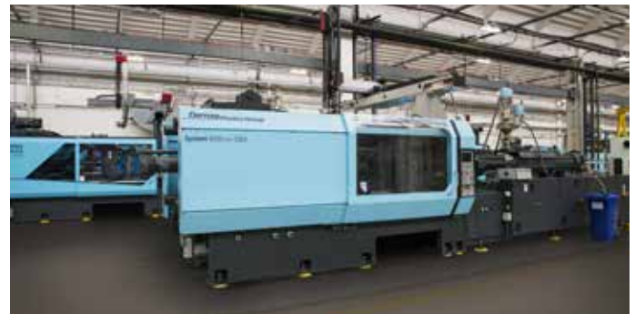
DEMAG, Locking force 4 200 – 6 500 kN
