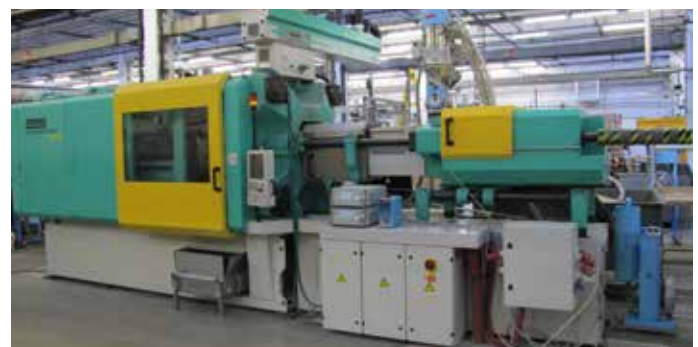
ARBURG, Schließkraft 4 600 kN
