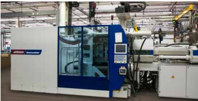
BATTENFELD, Schließkraft 6 000 – 8 000 kN
