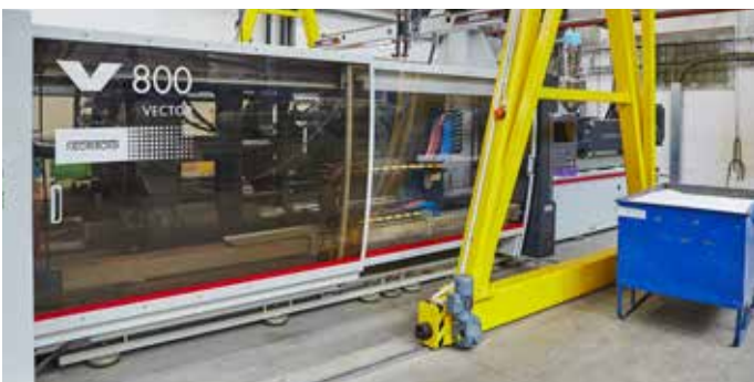
NEGRI BOSSI, Schließkraft 6 500 – 11 000 kN
